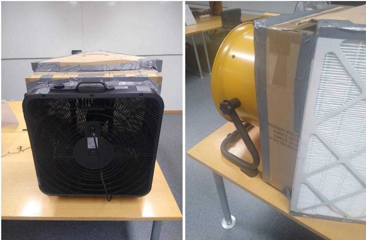
**Figur 2: Die untersuchten Raumreiniger. Links: Variante mit kleinerem Ventilator; rechts Variante mit leistungsstärkerem Gebläse**
